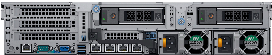
Vue arrière du serveur R740xd : avec fond de panier de 4 disques de 2,5 pouces installés
