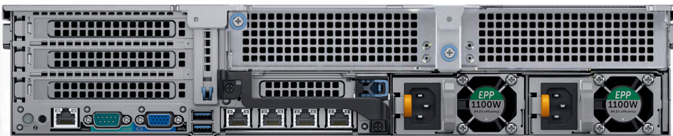
Vue arrière du serveur R740 : avec 4 logements PCIe disponibles avec caches de carte de montage 2 et 3
