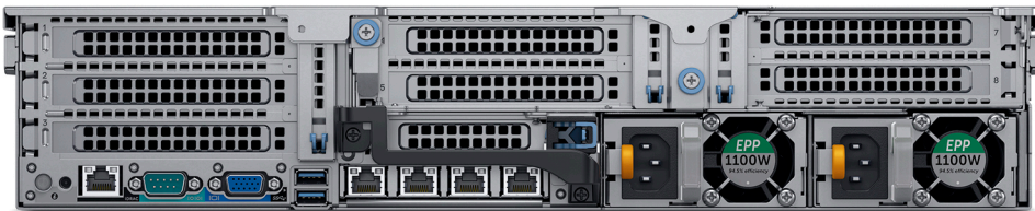
Vue arrière du serveur R740 : avec 4 logements PCIe disponibles avec caches de carte de montage 2 et 3
